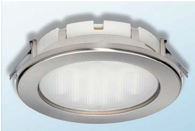
Abbildung 133 Leuchte für die Deckenintegration mit Energiesparlampe (9W) und einer Aufbauhöhe von nur 30 mm (Quelle: IDV GmbH)
