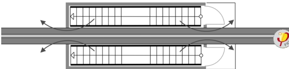
Abbildung 65 Wärmebrücke Kellerwand (Quelle: PHI, [64])
