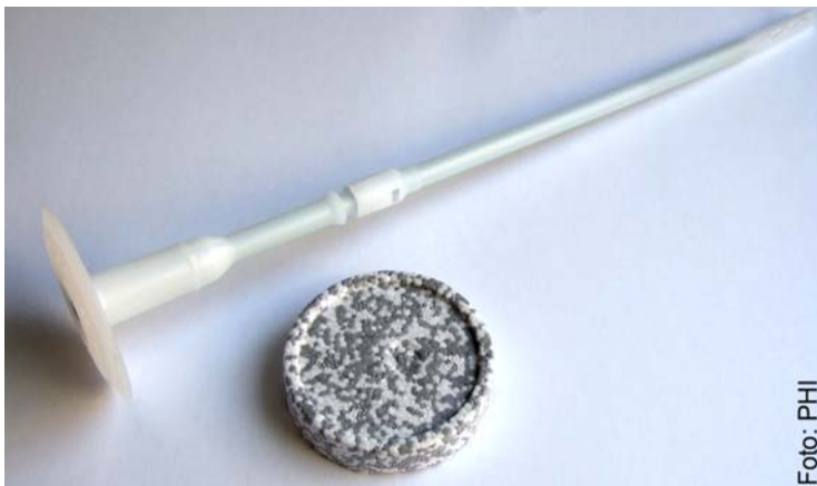
Abbildung 12 Edelstahldübel für Wärmedämmverbundsystem mit Kunststoffhülse und Kunststoffteller. Der Dübelkopf ist in einer trichterartigen Vertiefung versenkt, so dass er nicht bis zum Dübelteller reicht. Beim Festdrehen zieht sich außerdem der Dübel ca. 1cm weit in ein vorgesägtes zylindrisches Loch. Dieses wird dann durch den mitgelieferten Dämmstoffstopfen verschlossen. (Quelle: PHI)
