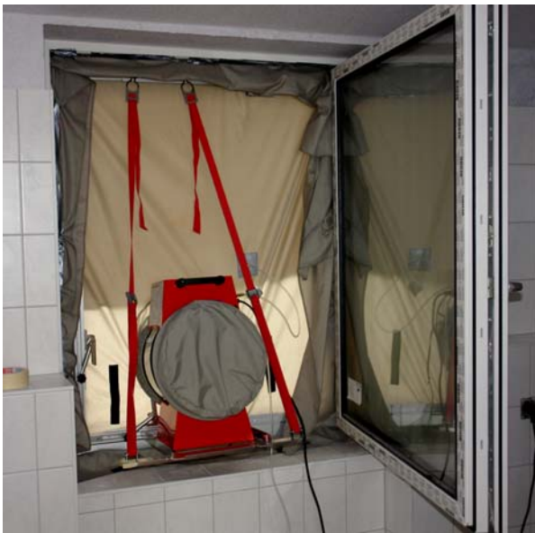
Abbildung 109 Nur wenn die Blower-Door in ein Fenster statt in die Haustür eingebaut wird, kann auch die Luftdichtheit der Haustür beim Drucktest überprüft werden. (Quelle: Architekt Schulze Darup, Sanierungsprojekt Bernadottestr., WBG Nürnberg)
