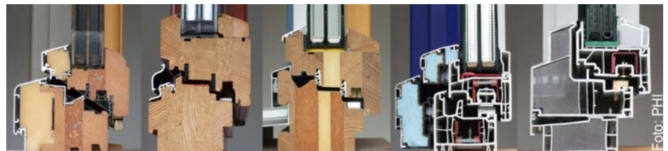
Abbildung 97 Gedämmte Fensterrahmen mit Dreifach-Verglasung im Querschnitt. Erkennbar ist die vergrößerte Bautiefe, sowie der erhöhte Glaseinstand der den thermisch getrennten Randverbund überdeckt. Von links nach rechts: Holz-PUR mit gedämmter Alu-Vorsatzschale, Holz-Kork, Holz-PUR, PVC mit gedämmter Alu-Vorsatzschale und thermisch getrenntem Aussteifungsprofil, PVC mit gedämmten Kammern (Quelle: PHI).
