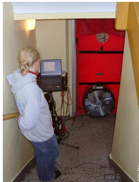
Abbildung 111 Prinzipieller Messaufbau für die Messung der Luftdichtheit (Quelle: [43])
