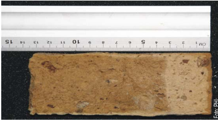
Abbildung 40 Querschnitt durch einen hydrophobierten Ziegelstein. Der Stein weist eine ungewöhnlich hohe Porosität auf, weshalb hier eine weit über dem üblichen liegende Eindringtiefe des Hydrophobierungsmittels von mehr als 3 cm erzielt wurde (heller Bereich). (Quelle: PHI, [205])
