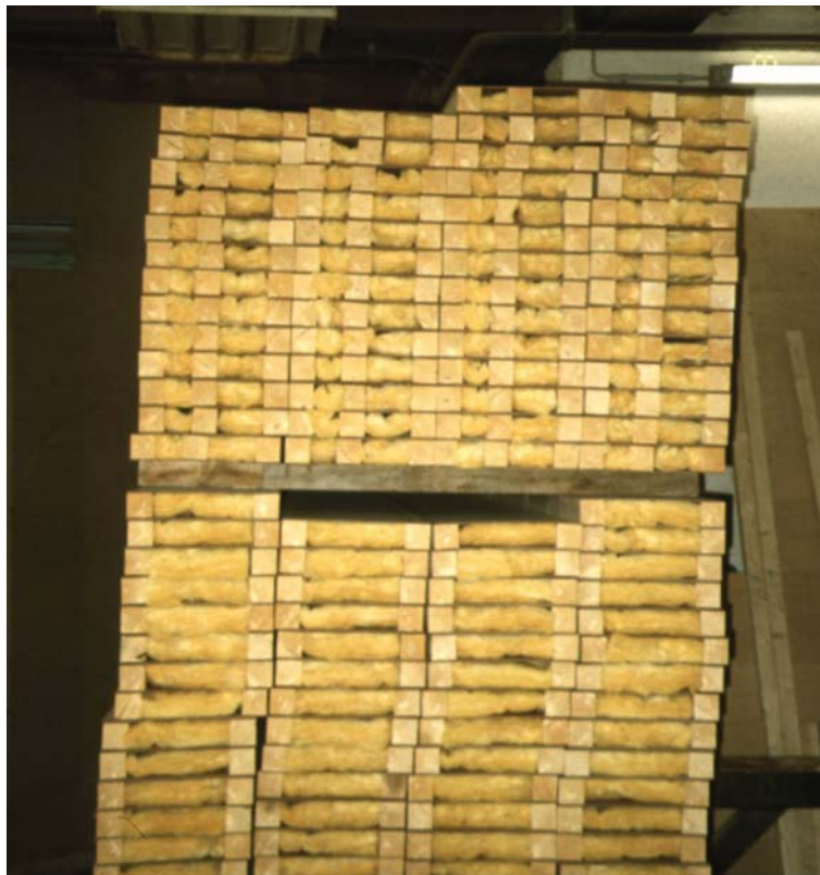
Abbildung 51: Mit Mineralwolle gedämmte Kastenträger, auf dem oberen Stapel: Spezial-Boxträger mit drei Holmen für den Fenstereinbau
