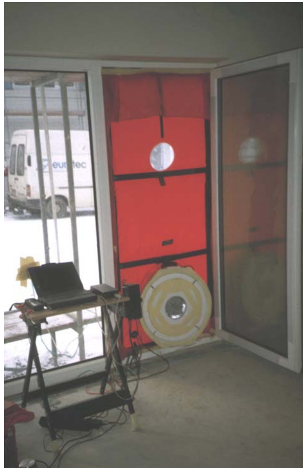
Abbildung 60: Eingebaute Blower Door in die geöffnete Terrassentür bei einer Messung in der Siedlung. Im Vordergrund Druckmessdosen und Laptop zur Datenaufzeichnung.
