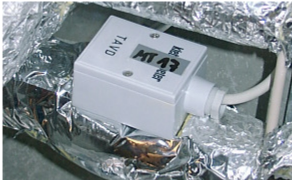
Abb. 16 und Abb. 17: Kalt- und Warmwassertemperaturmessung im Technikgeschoß (Anlegefühler). Beim Warmwassersensor (rechtes Bild) ist am linken Bildrand der Einstelldrehkopf des Brauchwassermischers zu erkennen. Im rechten Bildteil sieht man den Brauchwarmwasserspeicher.
