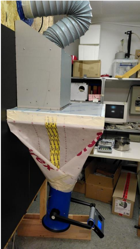
Abbildung 70: Messung des Haubenvolumenstroms mittels eines Flowfinders [PHI]
