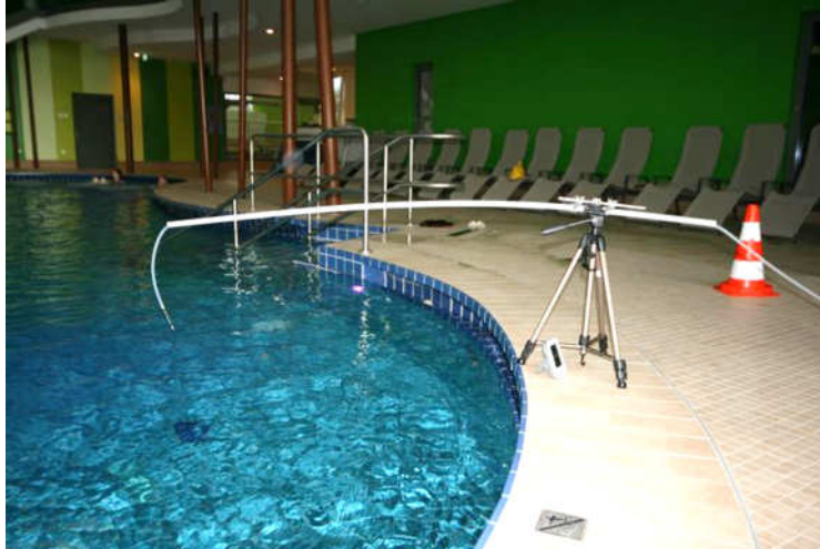
Abbildung 62: Messung von Trihalogenmethanen 20 cm über der Wasseroberfläche des Freizeitbeckens, Luftansaugung auf Aktivkohle
