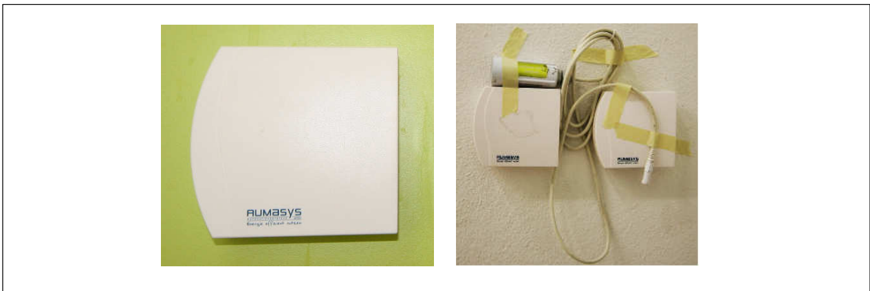
Abbildung 8: links: Wandsensor für Temperatur und relative Feuchte, rechts: Wandsensor mit Datenlogger zur Kalibrierung (temporär)
