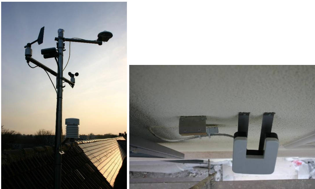
Abbildung 25: Wetterstation mit Messtechnik für Temperatur, relative Feuchte, Globalstrahlung, Wind und Niederschlag (links), Niederschlagssensor an der Fassade (rechts)
