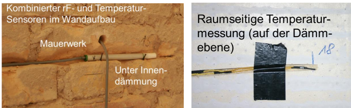
Abbildung 30: Kombinierte Feuchte- und Temperatursensoren im Mauerwerk und in der Ebene des alten Innenputzes (links), Raumseitige Temperaturmessung (rechts).
