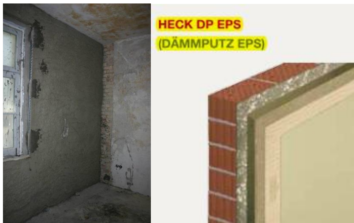
Abbildung 8: Heck-Dämmputz nach Anbringung der ersten Schicht (links), schematische Darstellung (rechts) Quelle: BASF
